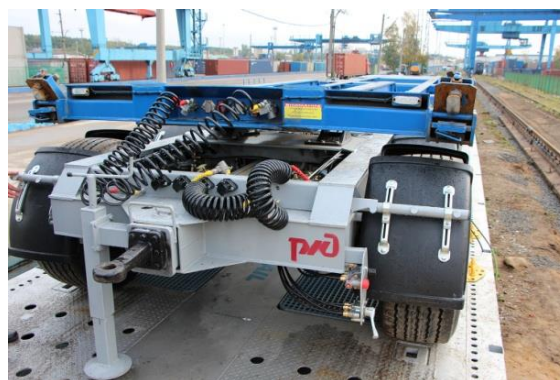
Рис. 5. Подкатная тележка типа «dolly» как средство крепления для вагона 13-9961
